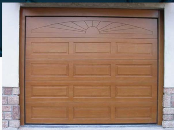
I portoni NaturA vengono realizzati con pannelli di Okumè, Larice, Abete ed essenze a richiesta, di spessore 44 mm. doppia parete in tre strati, da spessore 12 a 15 mm. con telaio interno in legno da spessore 15 a 20 mm. I pannelli sono trattati con prodotti all'acqua in tre mani, impregnatura fungicida, intermedio isolante e finiture di protezione.
