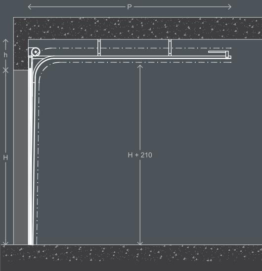
**Tip. MG - portone sterzati parabolici**
